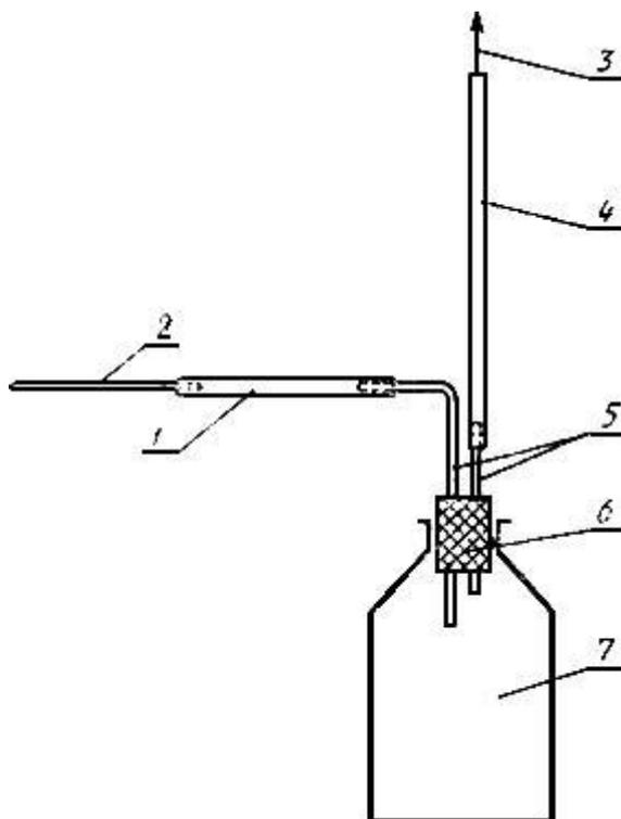
1 - трубка ПЭНД  $d_y$  - 6 мм,  $l \approx 600-700$  мм; 2 - острый наконечник для отбора пробы из мешка (титан или нержавеющая сталь  $d_y$  - 5 мм,  $l \approx 150$  мм); 3 - к вакуум-наосу; 4 - трубка ПЭНД  $d_y$  - 6 мм;
